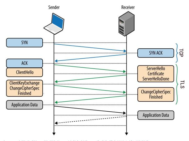
在TCP三次握手后的TLS握手阶段(即淡黄色部分)即为我们重点关注和检测的部分。
